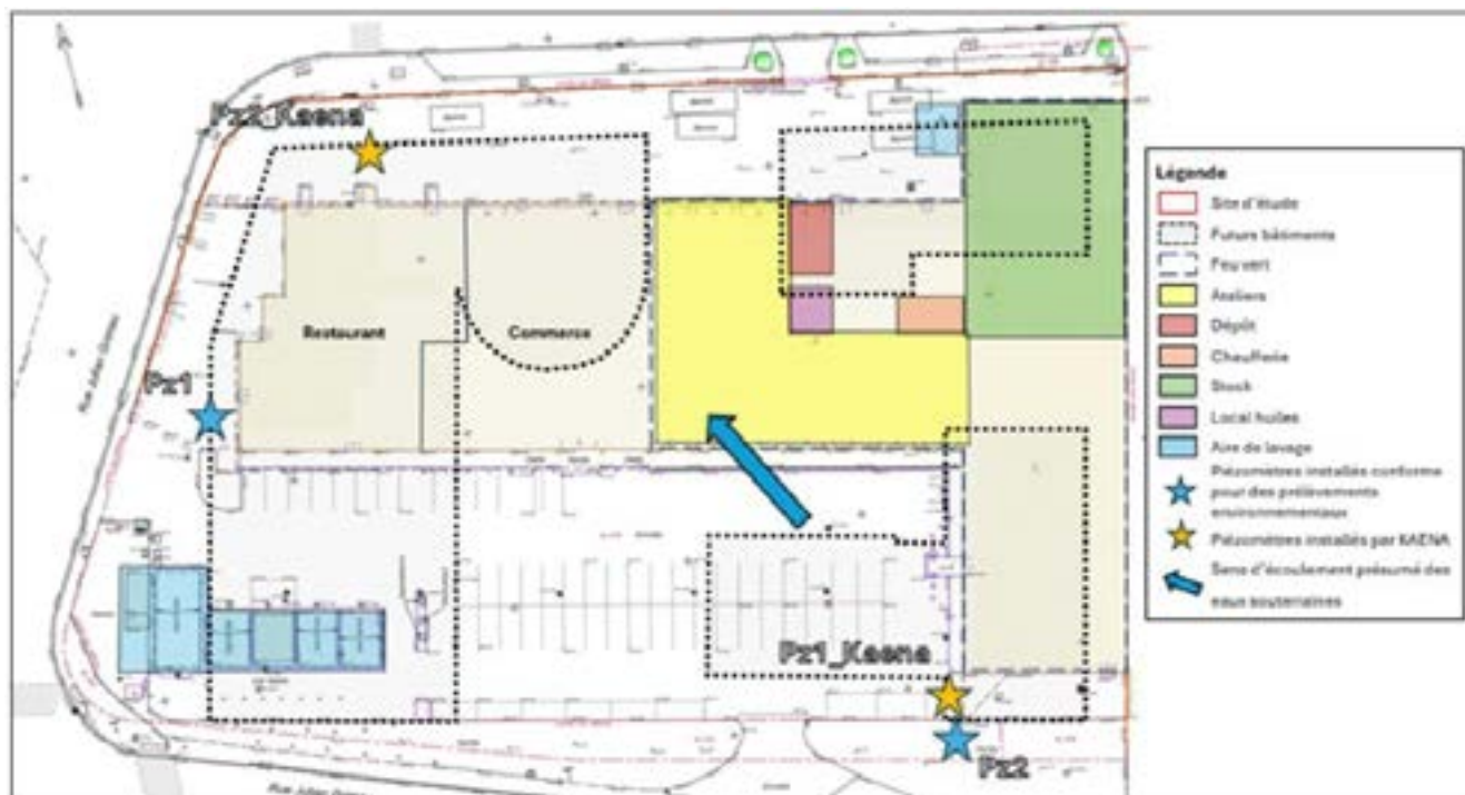
Localisation des prélèvements réalisés sur les eaux souterraines (Source : DEEP Environnement, novembre 2025)
