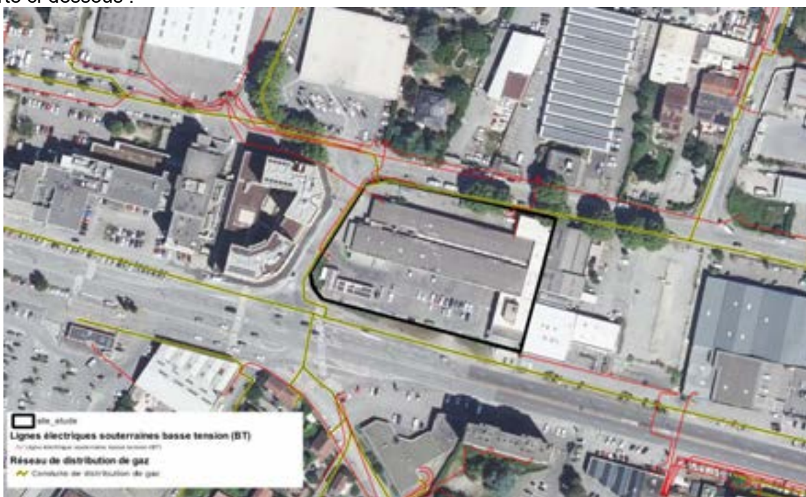
Réseaux électrique et gaz à proximité du tènement Feu Vert – Source : Craig
