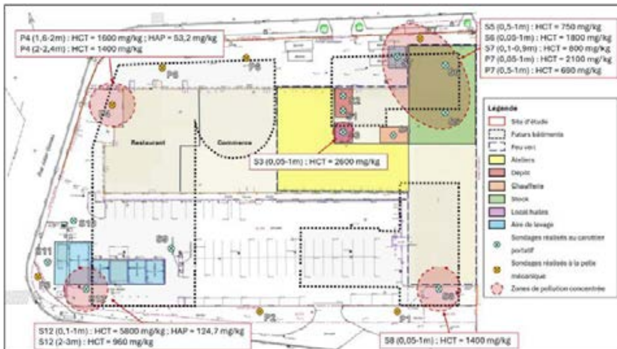
Localisation des zones de pollutions en hydrocarbures (Source : Deep Environnement, Novembre 2025)
