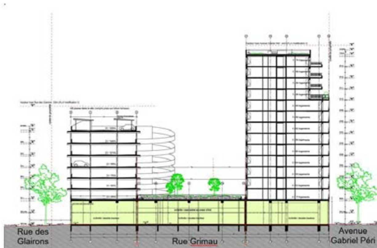
Coupe des bâtiments A et B du projet – Source : Icade
