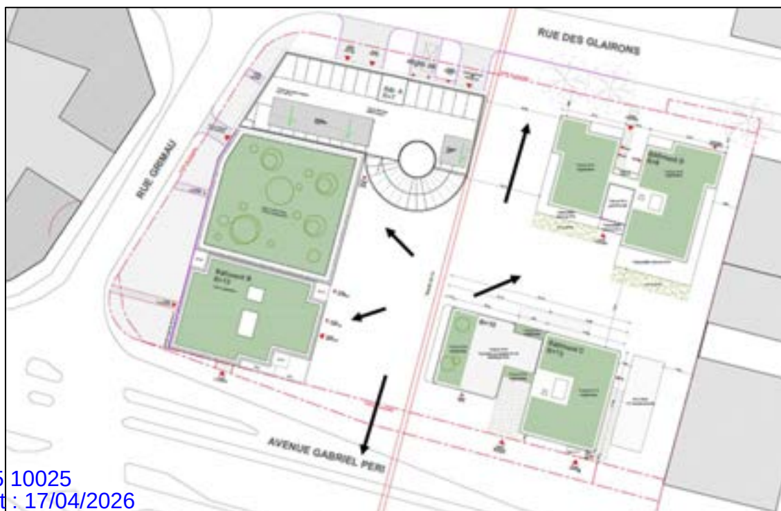
Vue des écoulements débordants des ouvrages de gestion du projet
