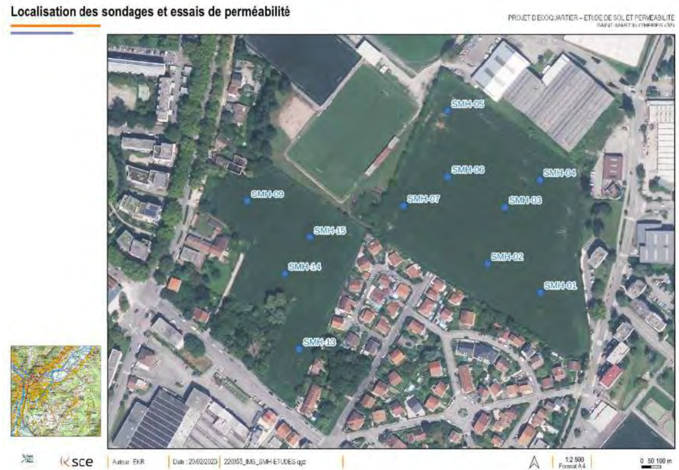
Figure 15 : Localisation des sondages et essais de perméabilité
