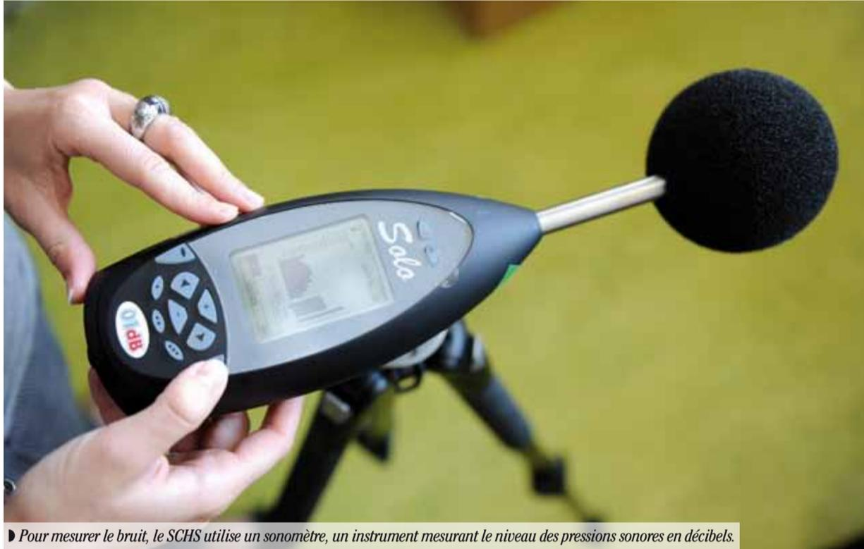
► Pour mesurer le bruit, le SCHS utilise un sonomètre, un instrument mesurant le niveau des pressions sonores en décibels.
