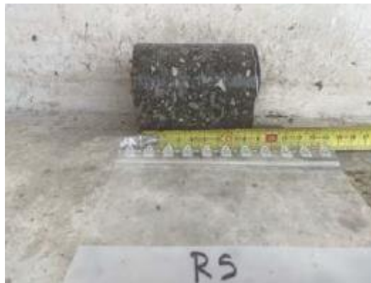
Figure 14 : Carottage réalisé sur l'un des ponts (épaisseur 8,5cm)
