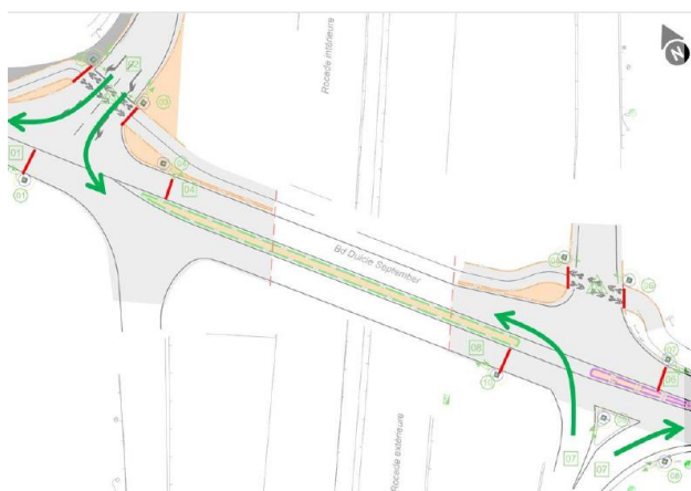
Figure 9 : Principe d'aménagement sans voie de tourne-à-gauche (phase 2)
