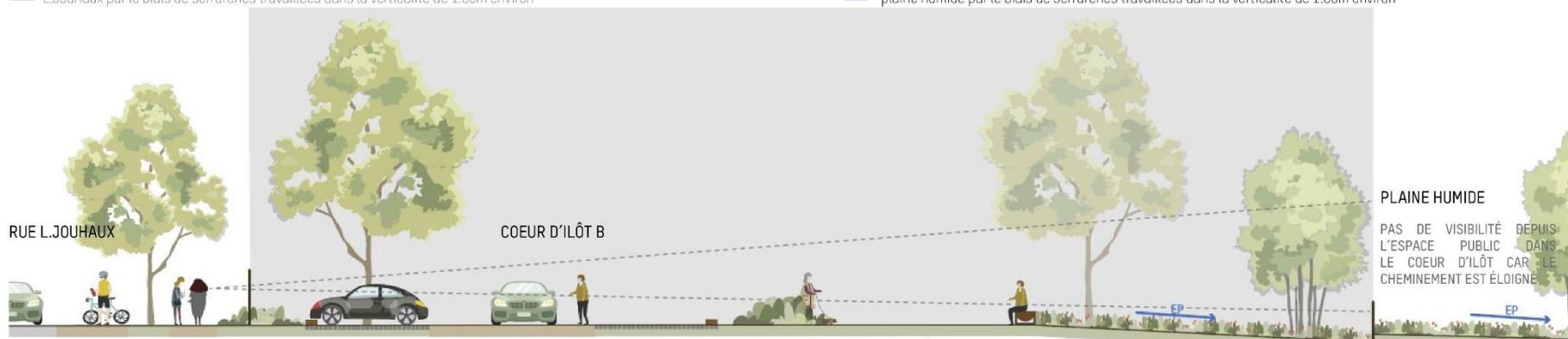
! LE PROFIL EN LONG ET EN TRAVERS DE LA NOUVE DEVRA ÊTRE ADAPTÉ DE MANIÈRE À ÉVITER LE RECOURS AU GARDE CORPS
